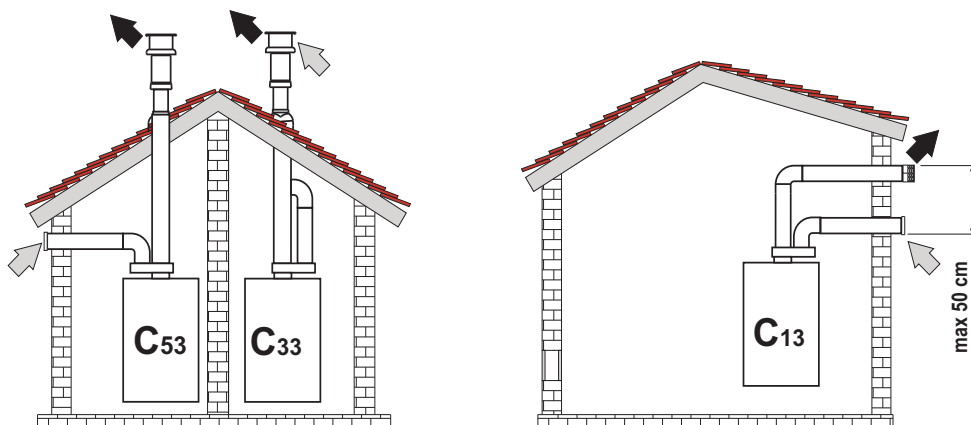
wygląd 34- Przykłady połączenia przewodami oddzielnymi
